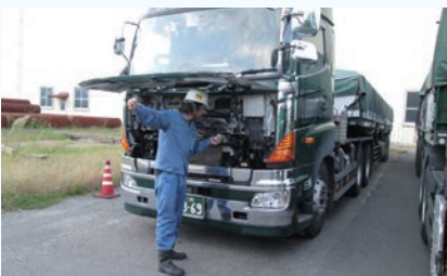
エンジンオイル点検
